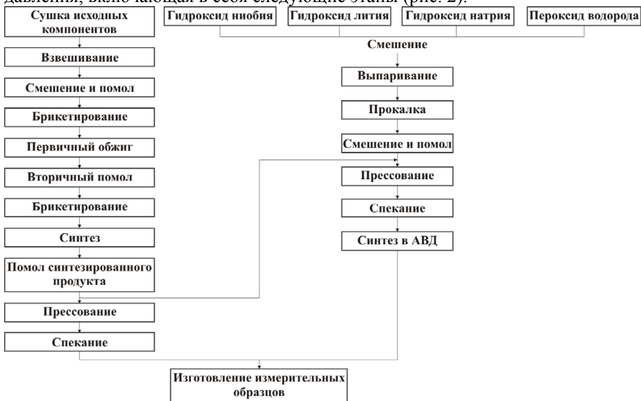
Рисунок 2 – Технологическая схема основных этапов синтеза сегнетоэлектрических керамических твердых растворов Li_xNa_{1-x}Ta_yNb_{1-y}O_3 .
