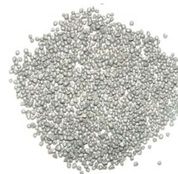
Рисунок 7 - Гранулы чугуна из частично восстановленного продукта
