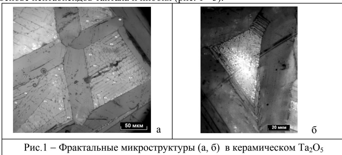
Рис.1 – Фрактальные микроструктуры (а, б) в керамическом  $Ta_2O_5$
