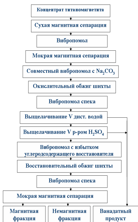
Рис.1. Принципиальная схема переработки ванадийсодержащих титаномагнетитовых концентратов
