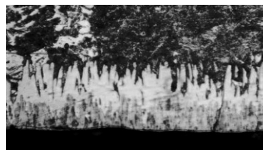
Рис.2. Армко-железо + В, 900^\circ\text{C} , 2 ч. Толщина боридного слоя – 115 \mu\text{м} , \text{FeB} - 52.8 \mu\text{м} , \text{Fe}_2\text{B} - 62 \mu\text{м}
