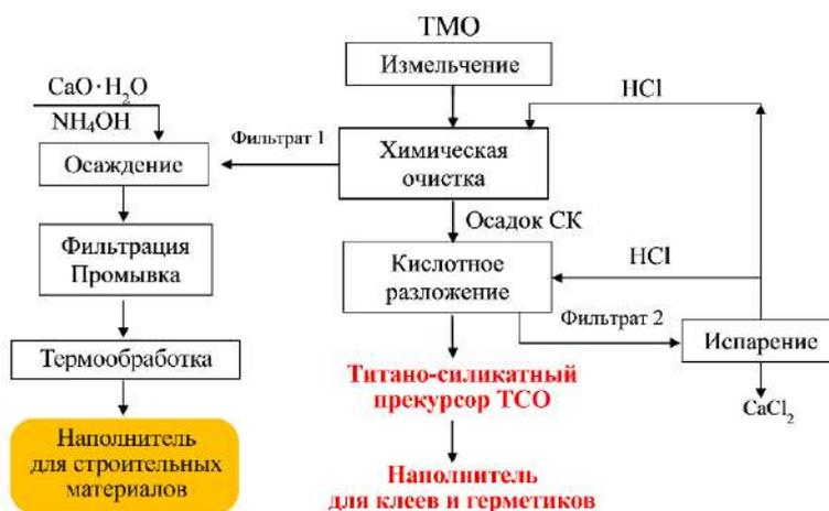
Рис. 1. Принципиальная схема переработки некондиционного сфенового концентрата
