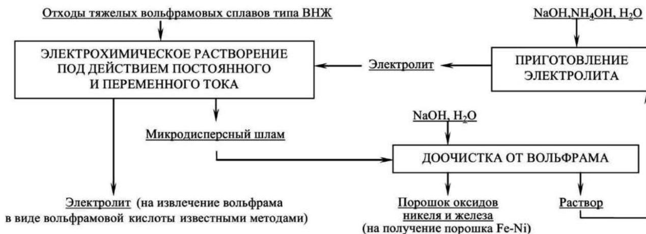
Рис. 2. Принципиальная схема переработки отходов тяжелых вольфрамовых сплавов типа ВНЖ
