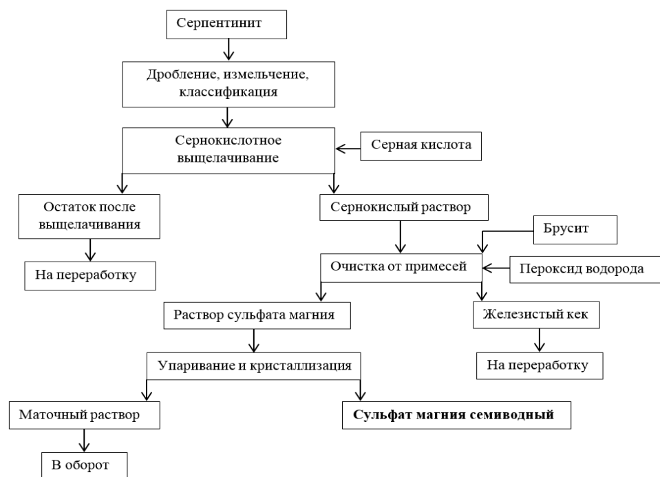
Рис. 3. Принципиальная технологическая схема переработки серпентинита сернокислотным способом
