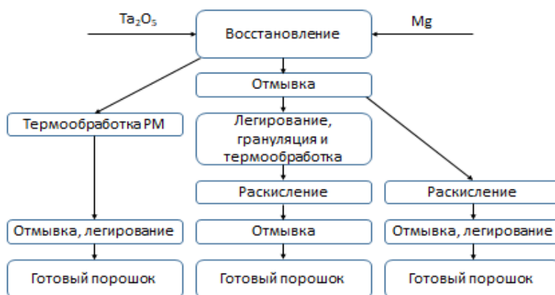
Рис. 2. Принципиальная схема получения магнетермического конденсаторного порошка
