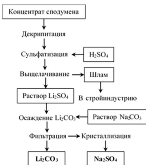
Рис. 4. Принципиальная схема получения карбоната лития из сподумена по сернокислотной технологии с элементами получения сульфата натрия
