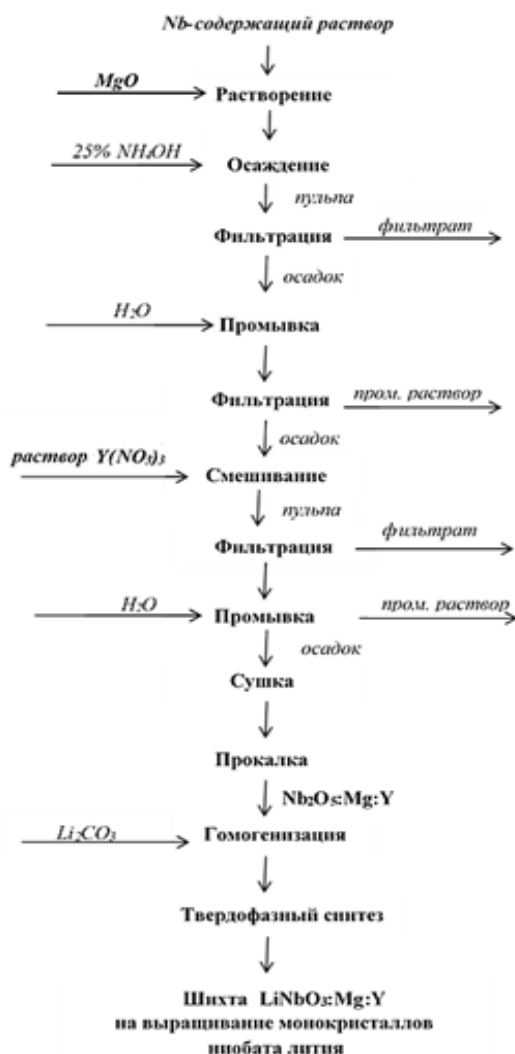
Рис. 1. Технологическая схема получения шихты \text{LiNbO}_3:\text{Mg}:\text{Y} методом гомогенного легирования
