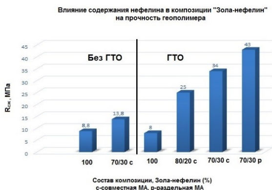
Рис. 5. Влияние состава композиции и условий твердения на R_{сж} геополимеров на основе смесей золы и НК в возрасте 180 сут. Время МА в мельнице: совместная МА — 180 с; раздельная МА — зола 180 с, НК 400 с, смешение 30 с
