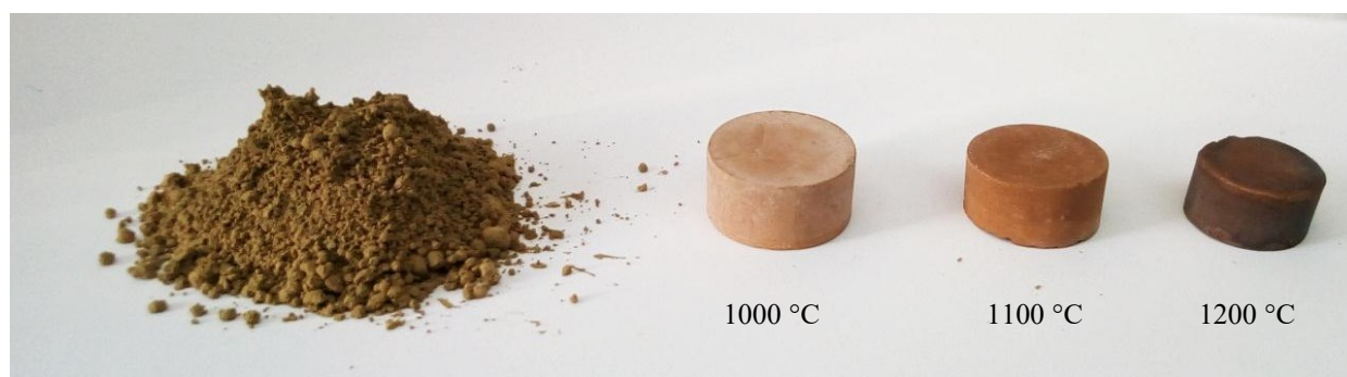
Рис. 4. Внешний вид исходной навески 2,7 \pm 0,2 г зольной фракции КА-3, используемой для получения таблеток керамических материалов (а), и образцы, полученные при различных температурах обжига (б)
