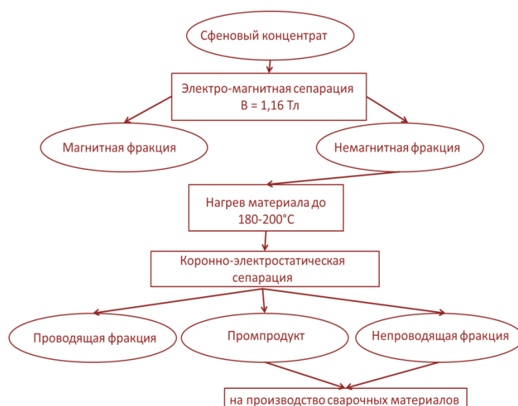
Рисунок 5.2 – Усовершенствованная схема радиационной очистки сфенового концентрата
