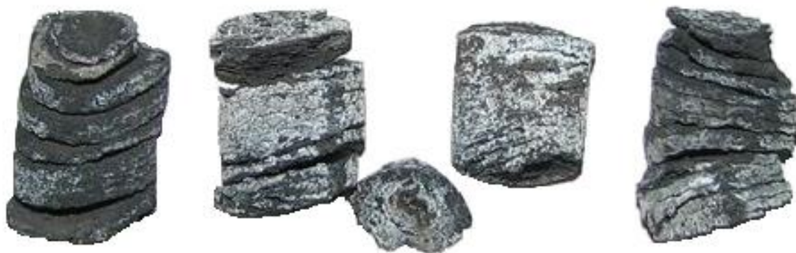
Рисунок 11 – Продукты магнитоермического восстановления в режиме СВС
