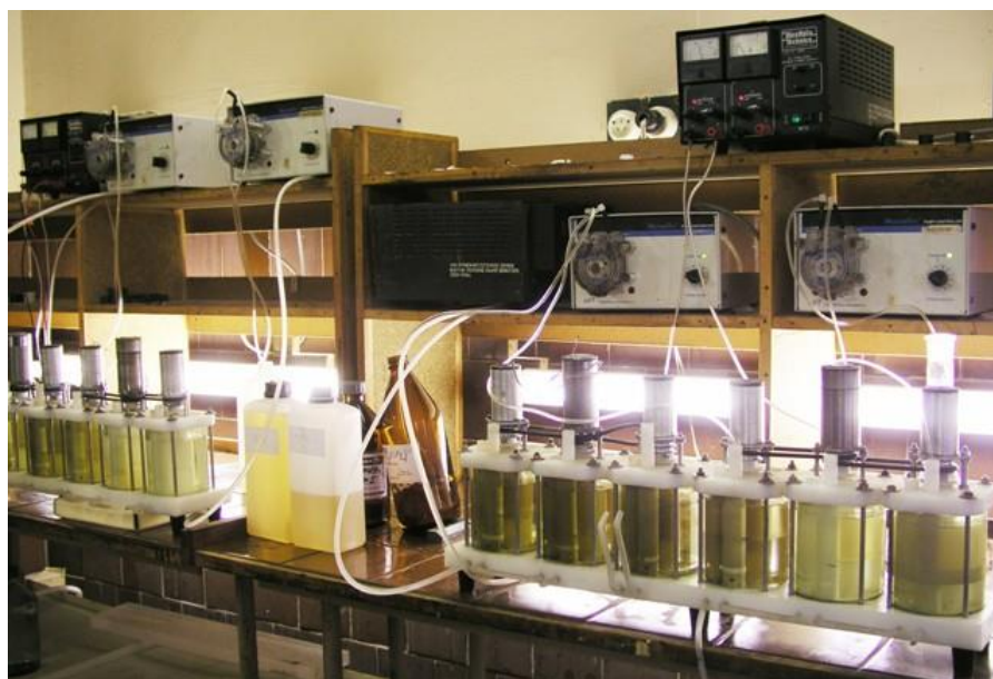
Рисунок 2 - Внешний вид установки для испытаний в непрерывном режиме - лабораторный каскад экстракторов смесительно-отстойного типа
