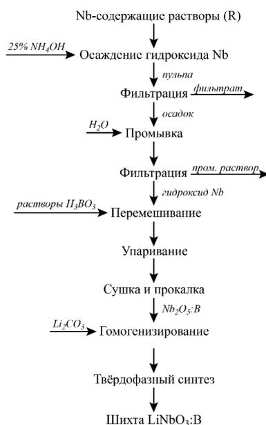
Рисунок 2.1 – Технологическая схема получения твердого прекурсора  $\text{Nb}_2\text{O}_5:\text{B}$  (0.0042 мас. % В) и шихты  $\text{LiNbO}_3:\text{B}$  (0.02 мол. %  $\text{B}_2\text{O}_3$  в шихте) [40]
