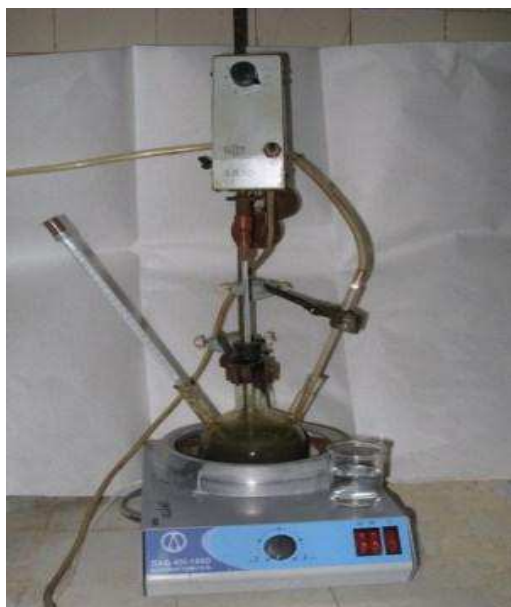
Рисунок 2.1. Установка для разложения сфенового концентрата
