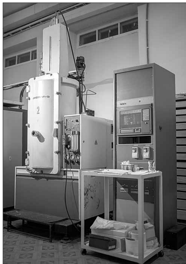
Установка «Кристалл-2» для выращивания монокристаллов методом Чохральского
